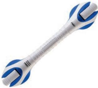
Barre d'appui équipée de deux ventouses à fixer sur une surface propre, plane, lisse et non poreuse. Ne doit pas être fixée sur les joints de carrelage, du plâtre, du bois et des surfaces tapissées. Ne nécessite aucun perçage et possède des indicateurs de sécurité avec témoin vert = fixation correcte, et témoin rouge = fixation incorrecte.
